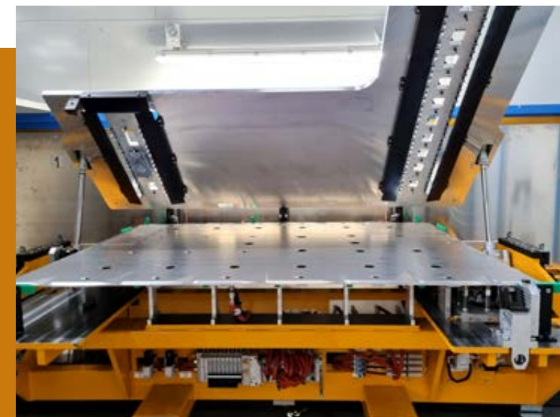
Unterfahrschutz in der Schweißvorrichtung.
